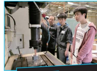
電極の形通りに金属が溶け、形を彫り込みます。
