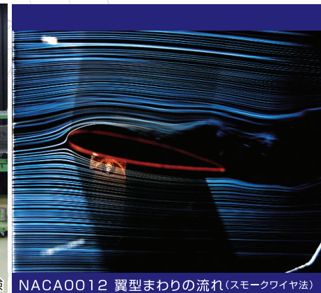
NACA0012 翼型まわりの流れ(スモークワイヤ法)
