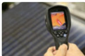
全世界に普及している太陽光発電システムの維持のために、太陽電池パネルの異常検出技術を研究しています。パネル内の不良太陽電池に生じた異常電圧の非接触検出や、異常発熱の赤外線カメラを用いた解析に取り組んでいます。
