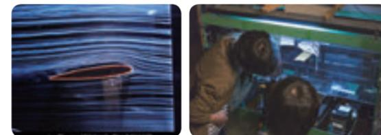
物体が受ける空気抵抗の影響を調べるための大型機材「3次元風洞(エッフェル型)実験設備」を完備しています。飛行機やロケットなどの設計において欠くことのできない空気力学について、実験を通じて実際に目で見て体験することで、より理解が深まるはずですよ。
