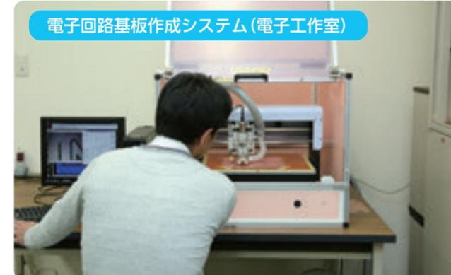
電子回路基板作成システム(電子工作室)
