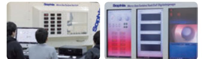
小型ながら本物のターボジェットエンジンを1分間に十数万回転で運転させ、実際の運転データをリアルタイムに計測します。取得した計測データを用いて自分で各種の性能を計算することで、ターボジェットエンジンの構造や性能を理解し、エンジニアとしての能力を取得できます。
