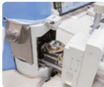
ジェットエンジンに使われる高温材料やその複合材料について研究しています。高温材料の開発は、材料を創り試験片に加工して、その強度や加工性を評価します。さらに、なぜそうなったのかを探るために、電子顕微鏡やX線回折装置を使って分析します。
