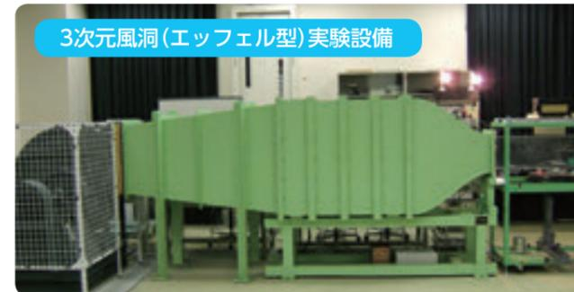
3次元風洞(エッフェル型)実験設備
