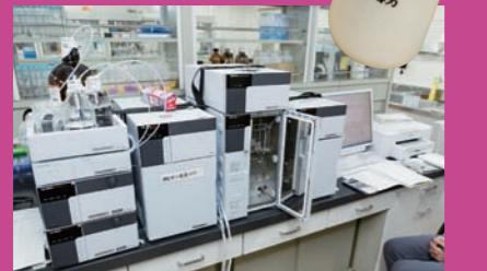
これが「高速液体クロマトグラフィー」。これを使って、グルコシルセラミドを精製します。
